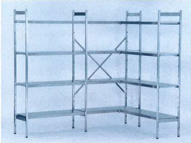
Grundregal mit Anbauregal mit Eckanordnung Bei Eckanbauregalen ist die Breite um 18 mm geringer als beim Grundregal.
